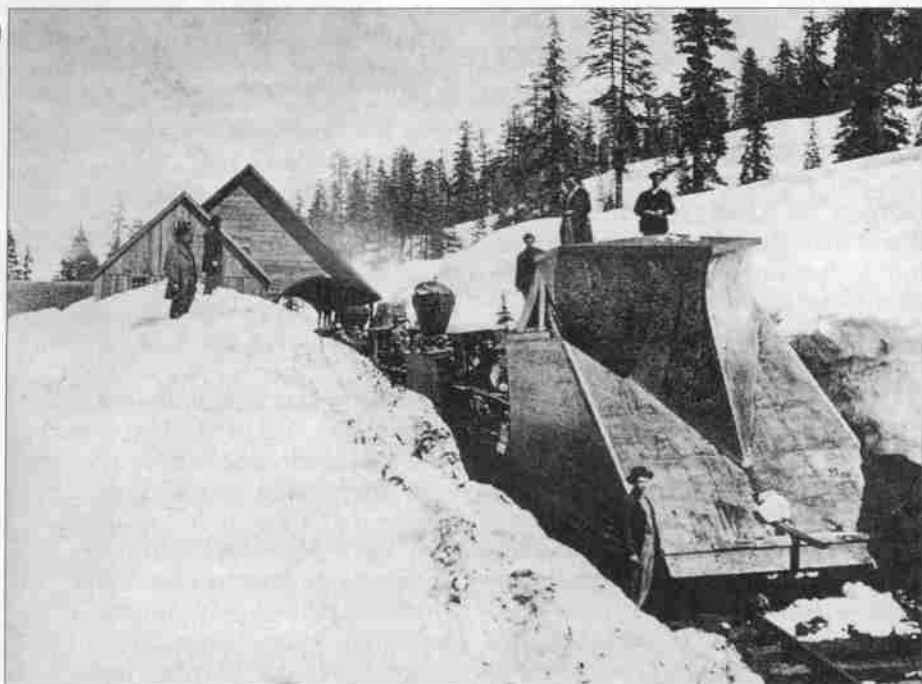
12 Lokomotiven wurden gebraucht, um diesen Bucker-Schneepflug im Winter 1867 durch neun Meter hohe Wächten in der Sierra zu schieben.
