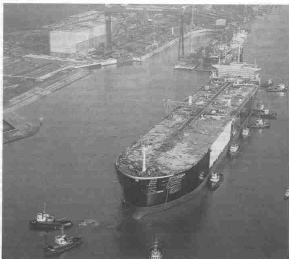
Stapellauf des 315 000 tdw tragenden SHELL-Tankers „LAGENA“. Das Bugsieren übergroßer Tankerkolosse erfordert den Großeinsatz von 11 bis 14 Schlepper.
