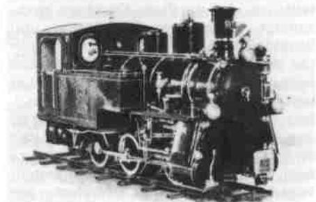
Betriebsfähiges Modell der Brünig-Berglokomotive 1051 im Maßstab 1:5,5.
